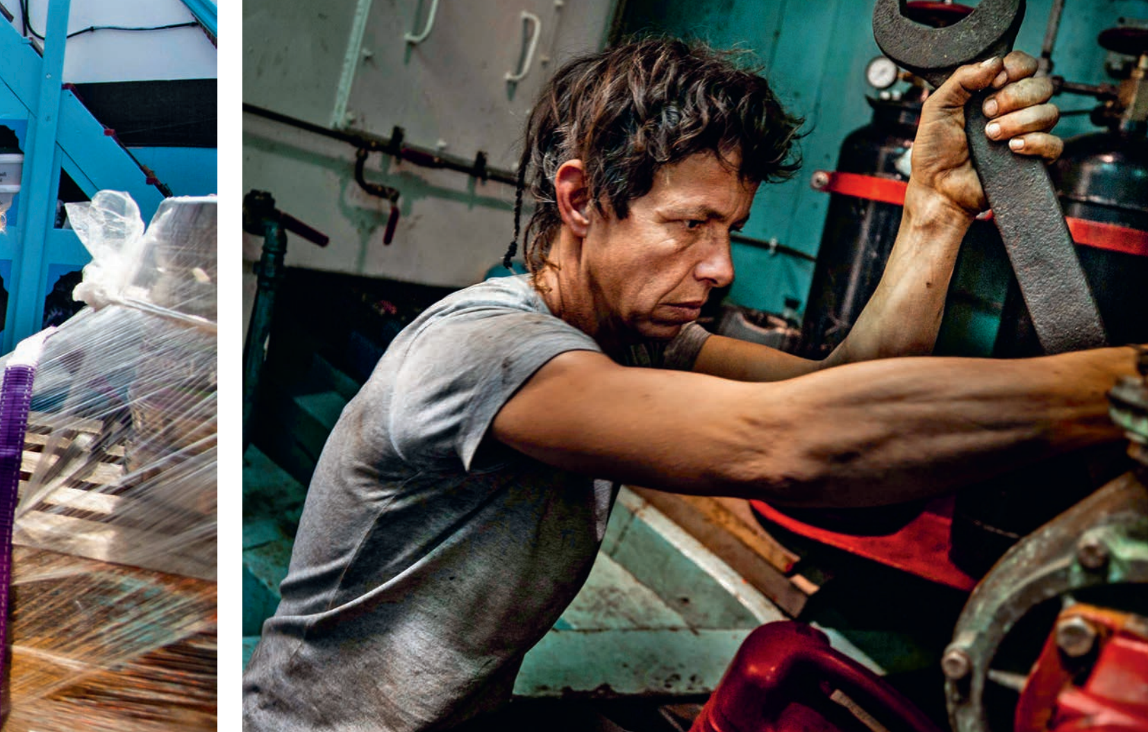
Gwen et le moteur Baudouin, un 6 cylindres de 120 chevaux, fidèle compagnon de route de la gabare depuis son installation à bord en... 1956.
